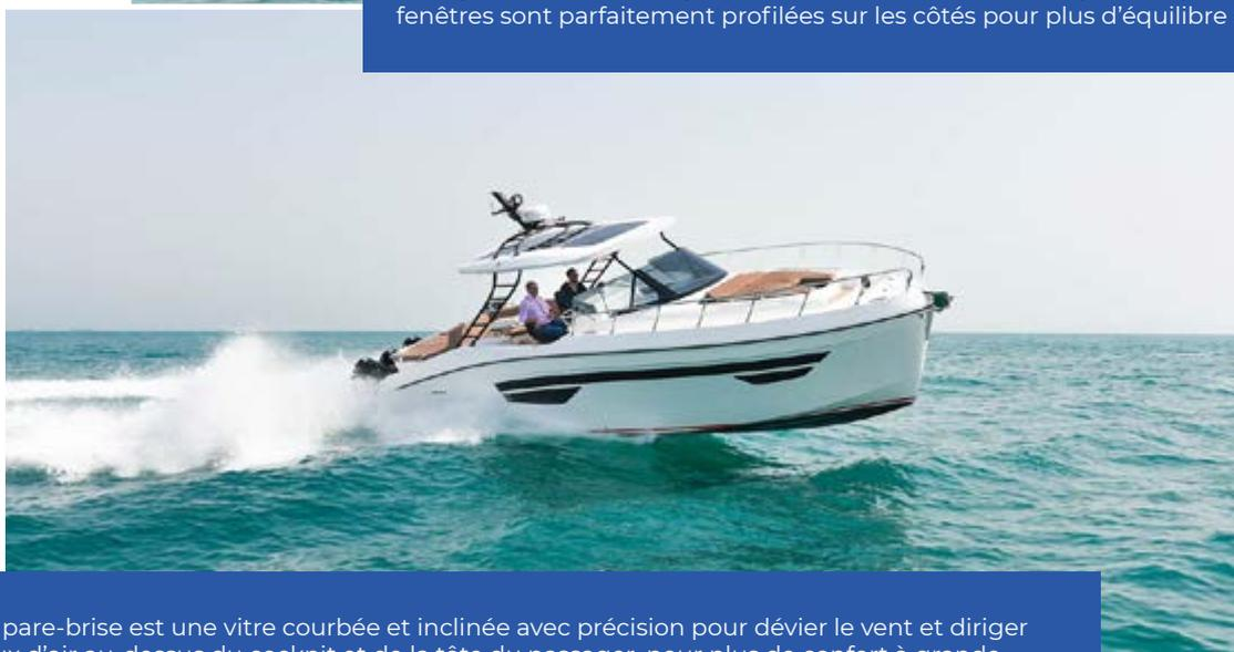
Son pare-brise est une vitre courbée et inclinée avec précision pour dévier le vent et diriger le flux d'air au-dessus du cockpit et de la tête du passager, pour plus de confort à grande vitesse. L'utilisation intelligente de l'espace à bord permet au capitaine et aux passagers de se déplacer sans difficulté.
